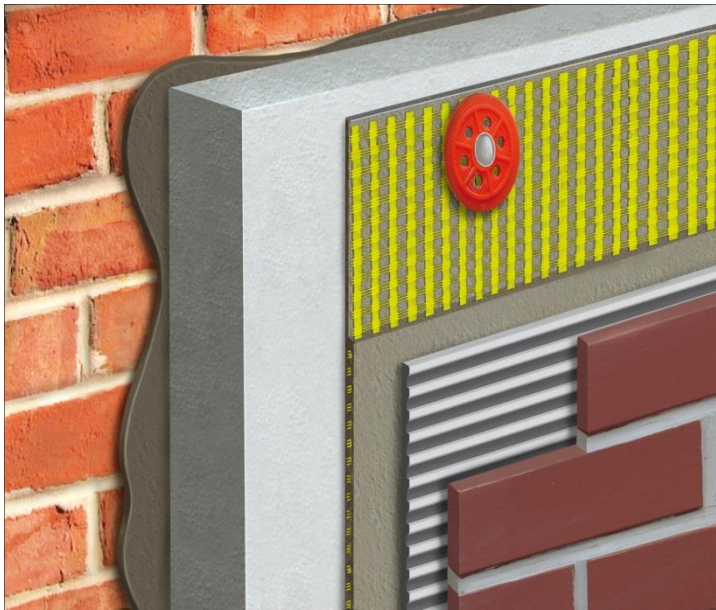
18 pav. Plokštės visada papildomai mechaniškai tvirtinamos smeigiuojant per tinklelį, šlapiuoju būdu.
